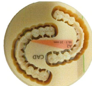
Fig.4 人工歯PMMAディスク
